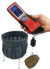
Como medir a Densidade: Colocar a Amostra no ar
